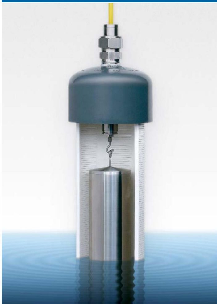
O modelo 4675LV com seção transversal revelando seus componentes internos: um peso cilíndrico suspenso por um transdutor de força de fio vibratório.
